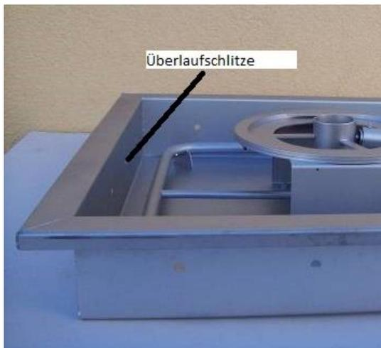
Den AISCO-Firetrainer E100 bis zu den Überlaufschlitzen der Wasserbadwanne mit Wasser befüllen.
