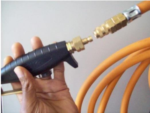
**Tastengriff mit 3 m Gasschlauch inkl. Schnellverschluss aus dem Notfall-Koffer nehmen.**
