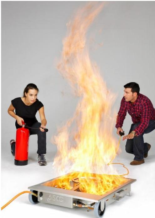
Der AISCO Firetrainer E100 dient zur Simulation eines Brandfalls, der Brandarten A oder C sowie B
