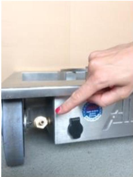
Propangasschlauch über Schnellverschluss an den Technikkasten des AISCO Firetrainer E 100 anschließen.
