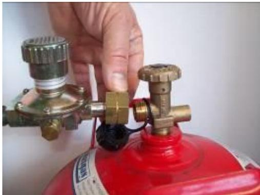
Propangasschlauch über Druckminderer an eine handelsübliche 5 kg bzw. 11 kg Propangasflasche anschließen. (Achtung Linksgewinde)
