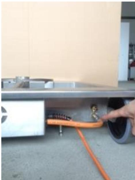
Gasverbindungsschlauch von dem Technikkasten an den jeweiligen Brenner (Punkt oder Flächenbrand) anschließen.
